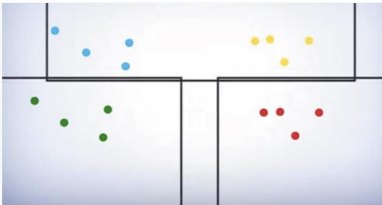
Пространственные координаты каждой точки вычисляются методом триангуляции: от каждой точки съемки к выбранной точке автоматически проводится линия зрения, и их пересечение дает искомое значение
