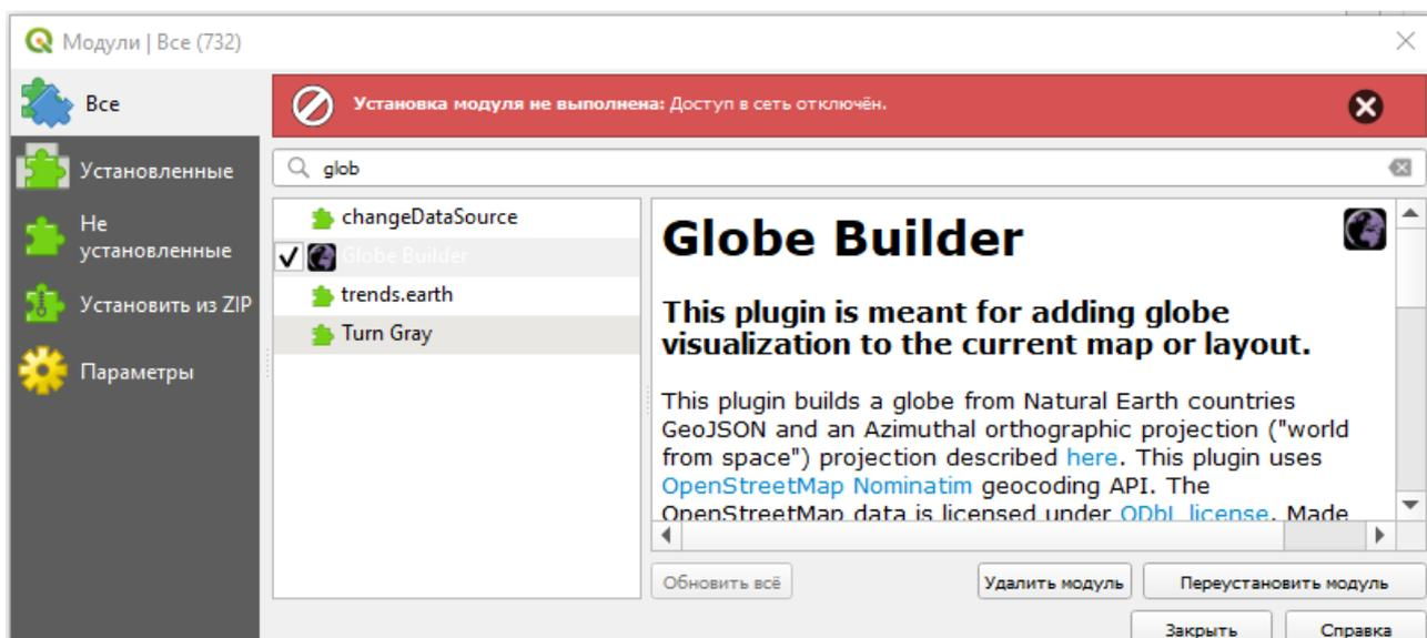
Установив его, переходим в главное меню программы модули Globe Builder - Build Globe, при необходимости ставим галочки в Data sources, и получаем вот такое изображение.
