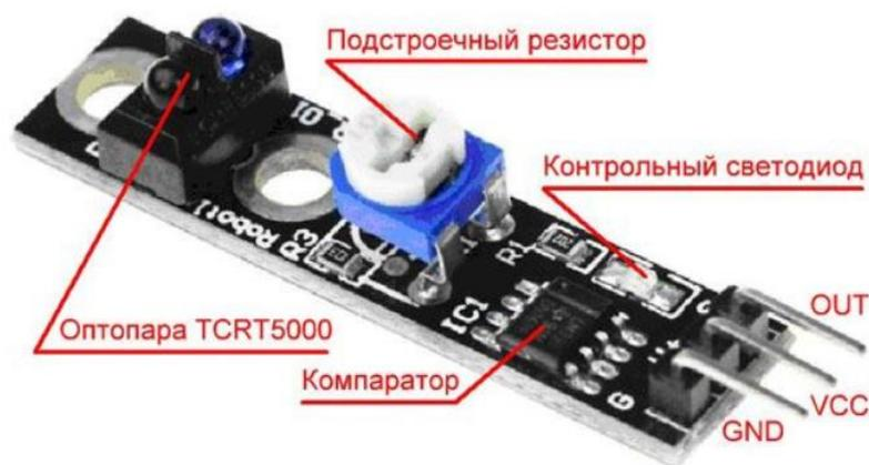
Рисунок 4. Внешний датчика линии.
