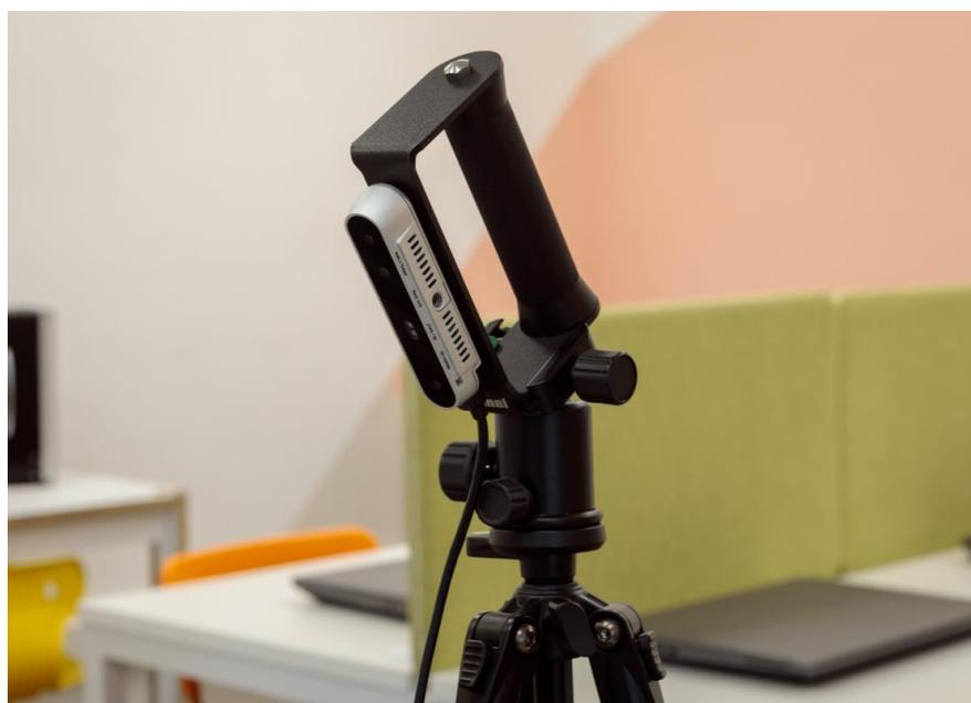
*Рисунок 2: Установка 3D сканера Planeta 3D на штатив*
