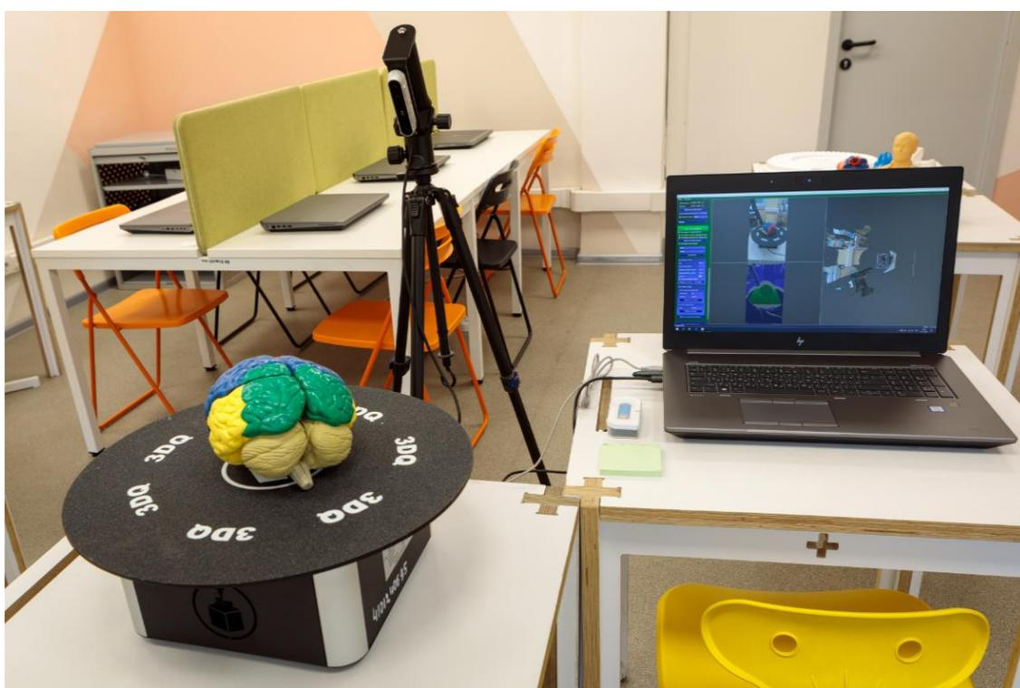
*Рисунок 3: Настройка 3D сканера на объект*
