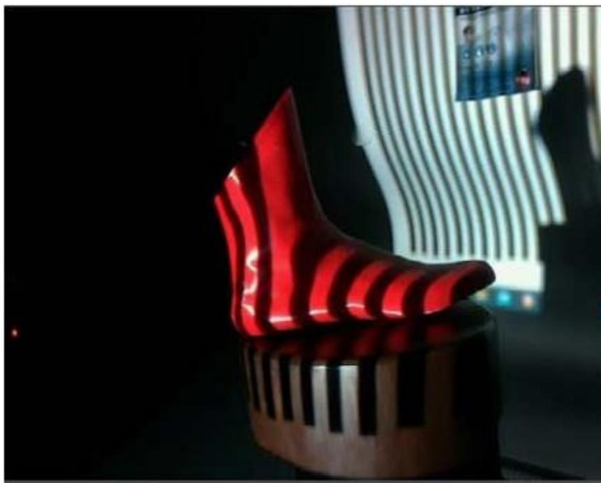
*Рисунок 3 Сканирование однотонного объекта*
