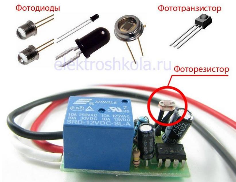
*Рисунок 1. Пример фотоприборов.*
