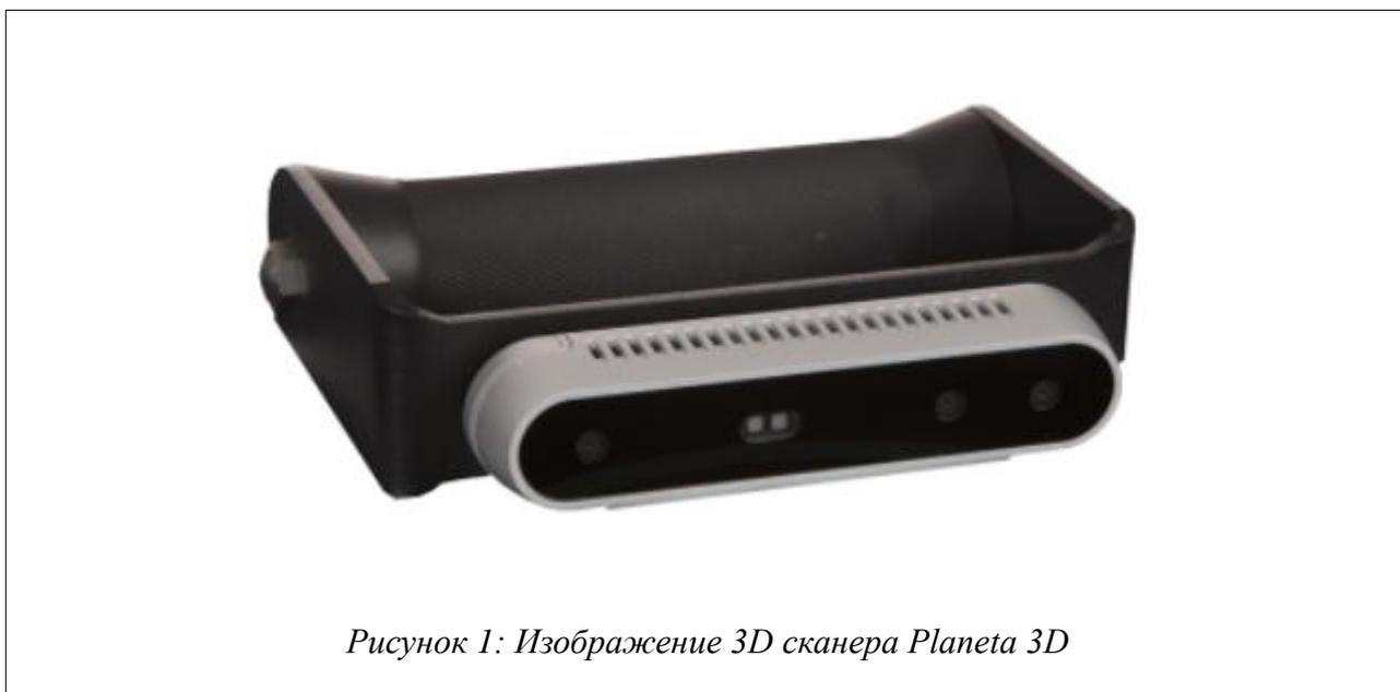
Оптический сканер работает по технологии структурированного света. Устройства, построенные на базе технологии структурированного света, работают не с лазерным, а естественным источником света. Такие устройства проецируют определенный ряд световых паттернов на целевой объект. Отраженное изображение затем захватывается камерами и положение каждой точки на поверхности объекта рассчитывается исходя из полученных искажений паттерна.
