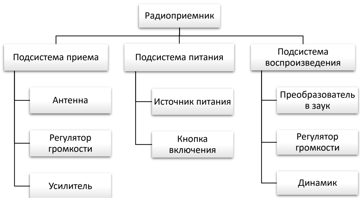
Рис. 83. Иерархия состава системы «Радиоприемник»
