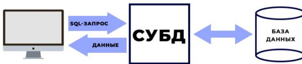
Рис. 130 Схема функционирования СУБД
