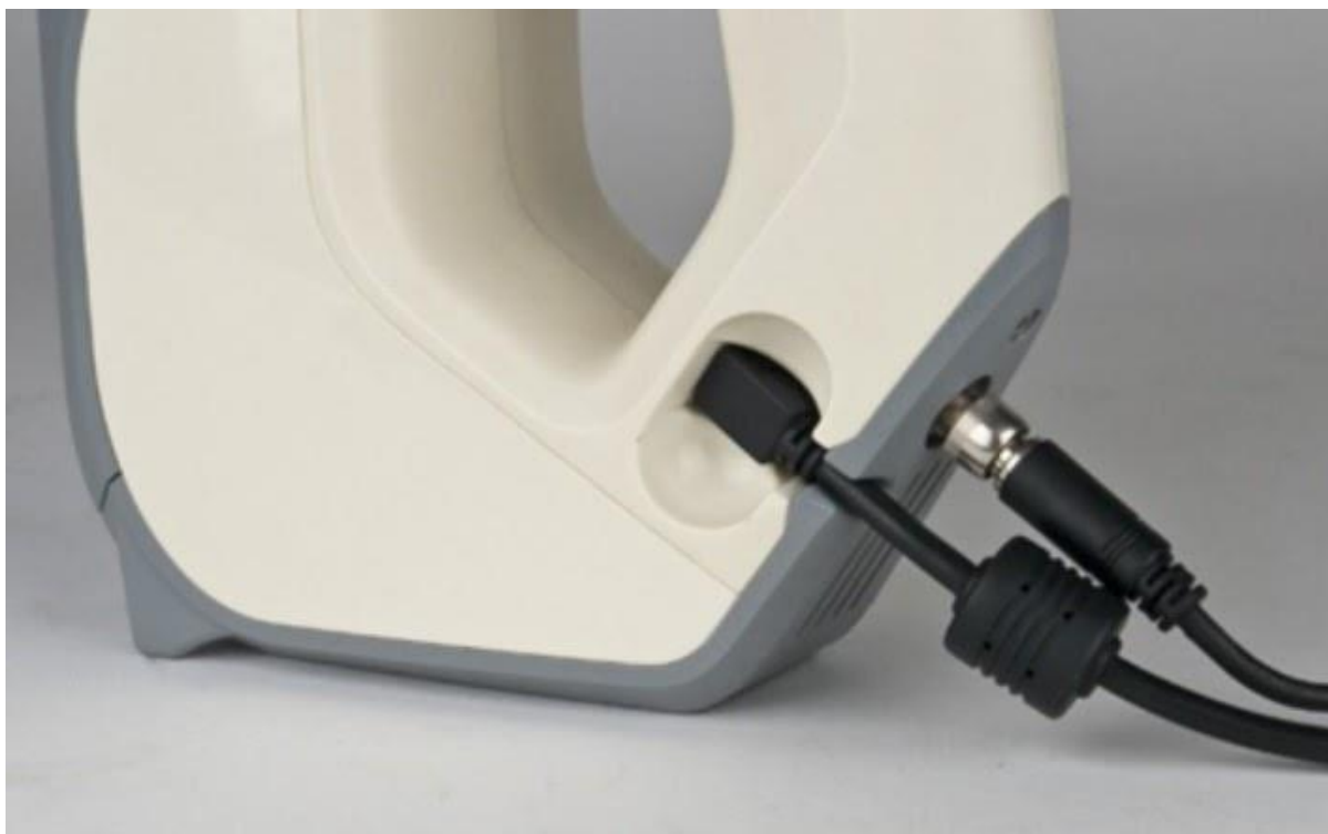
Рис. 2. Подключение проводов 3D-сканера Artec Eva
